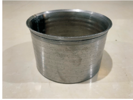
图 20 Q235 碳钢筒体双辊夹持旋压件
